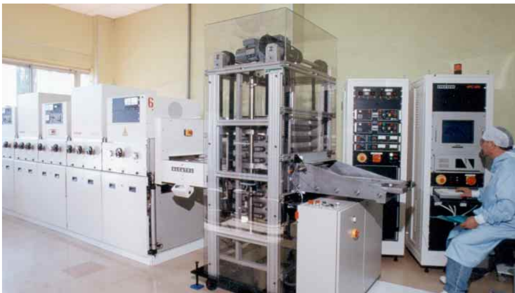
Dépôt de couches minces par pulvérisation cathodique. Vue d'ensemble de la machine utilisée pour la fabrication de guides supermirrors (photo CILAS).
