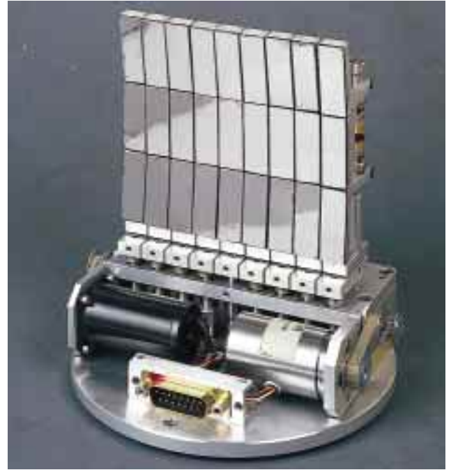
Montage à focalisation variable dans les 2 plans (analyseur IT). Assemblage de cristaux plans à orientation modulable permettant de faire varier les courbures de l'ensemble.
