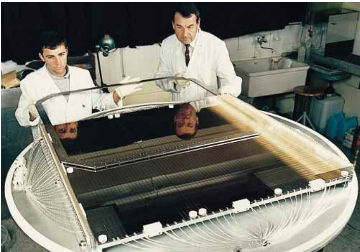
Multidétecteur XY de 64x64 cellules, en cours d'assemblage (photo ILL).
